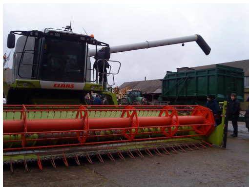
Billede 1: Forlænget snegl på mejetærsker for at kunne holde frakørselsvognen i næste kørespor.
